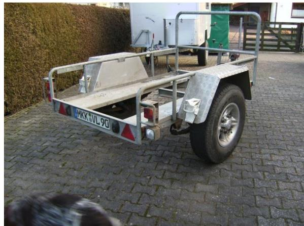
Hier befinden sich 2 Standschienen für den Fahrzeugtransport von ATV's, kleinen Traktoren, oder für den Holztransport.
